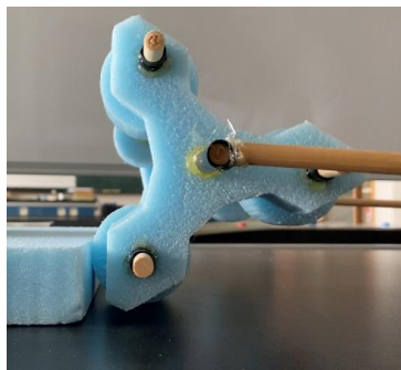
図 5 タイヤが段差を乗り越える様子。(A) は三輪型のタイヤ、(B) は扇型のタイヤのうち扇で乗り越える段階、(C) は内輪で乗り越える段階。
