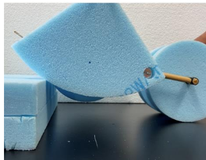
図 5 タイヤが段差を乗り越える様子。(A) は三輪型のタイヤ、(B) は扇型のタイヤのうち扇で乗り越える段階、(C) は内輪で乗り越える段階。
