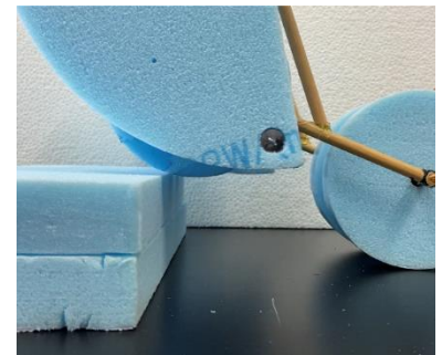
図 5 タイヤが段差を乗り越える様子。(A) は三輪型のタイヤ、(B) は扇型のタイヤのうち扇で乗り越える段階、(C) は内輪で乗り越える段階。
