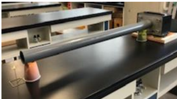
図1：実際に使用した音波消火器
